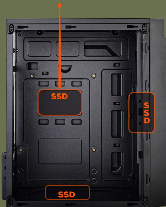
Ajuste o SSD na posição correta, de forma que as furações do SSD se alinhem com a furação do gabinete, então utilize os parafusos correspondentes para fixação.
